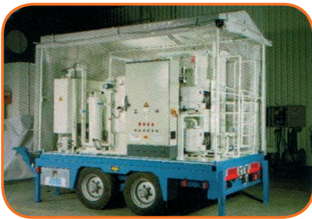
Appareil : MAXEI MASS 2000, débit : 2000 litres/heure
